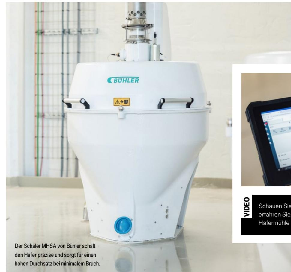
Der Schäl器 MSHA von Bühler schält den Hafer präzise und sorgt für einen hohen Durchsatz bei minimalem Bruch.
