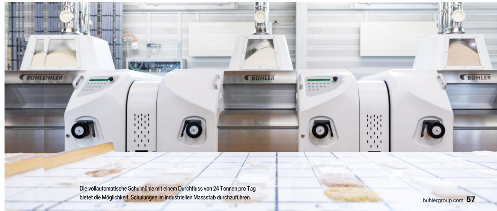
Die vollautomatische Schulmühle mit einem Durchfluss von 24 Tonnen pro Tag bietet die Möglichkeit, Schulungen im industriellen Massstab durchzuführen.
