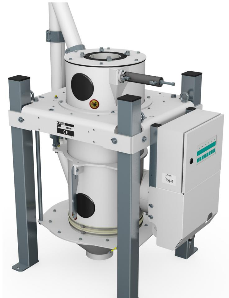
Differential-Dosierwaage MSDH – für die genaue Regelung und Messung von Getreide
