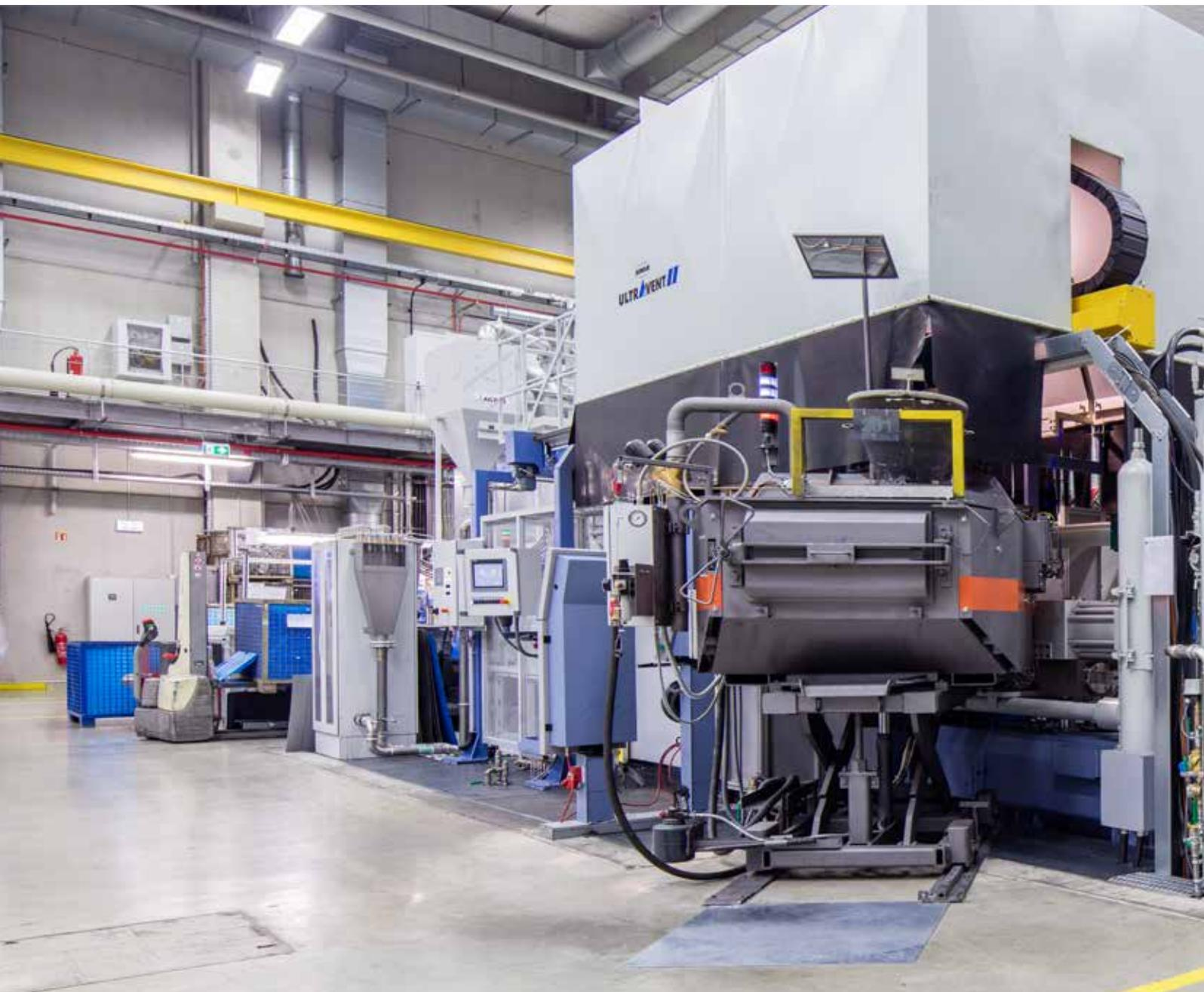
Eine hohe Verfügbarkeit der Giesszelle erfordert optimal aufeinander abgestimmte Anlagenkomponenten. Die Bühler Peripheriegeräte lassen sich über die DataView Kontrolleinheit einrichten, programmieren und steuern. Somit sind nicht nur Analyse- und Diagnosemöglichkeiten verfügbar, sondern auch die relevanten Parameter und Daten werden zentral gespeichert.
