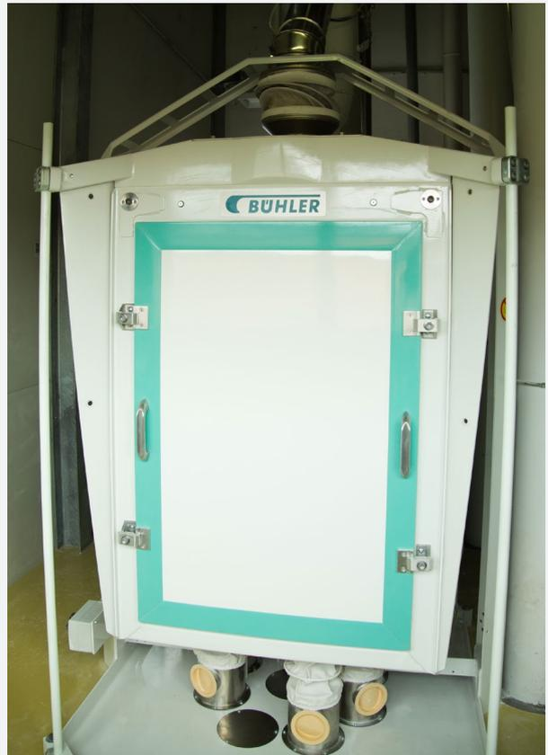
Der neue Kleinplansichter MPAU wird für schrot- und mehlintige Produkte in Weizen-, Roggen-, Mais- und Hartweizenmühlen zur Nachsichtung direkt nach der Vermahlung oder vor der Absackung eingesetzt.
