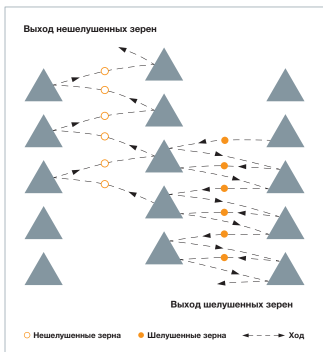
Принцип работы падди-машины Twitor®.
