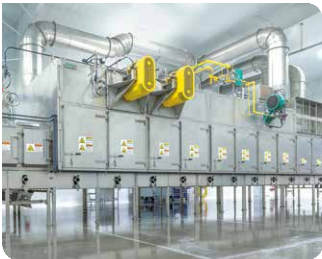
AeroRoast™ – ленточная сушилка и обжарочная печь высокой производительности
