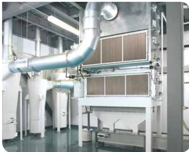
Вертикальный обжарочный аппарат RoaStar от Бюлер Барт с двумя зонами обжарки и одной зоной охлаждения
