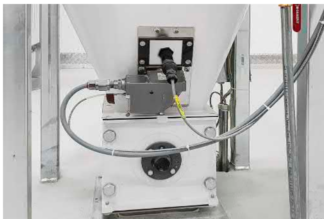
Компактный ИК-датчик подходит для модернизации существующих производственных установок.
