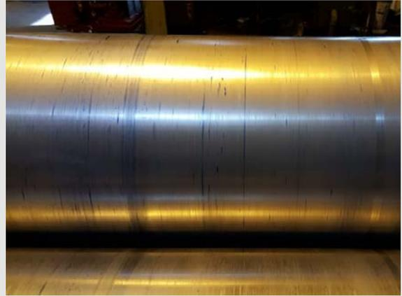
Los cilindros se deben volver a rectificar.
