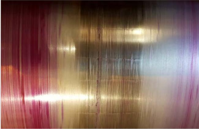
Los cilindros se deben volver a rectificar.
